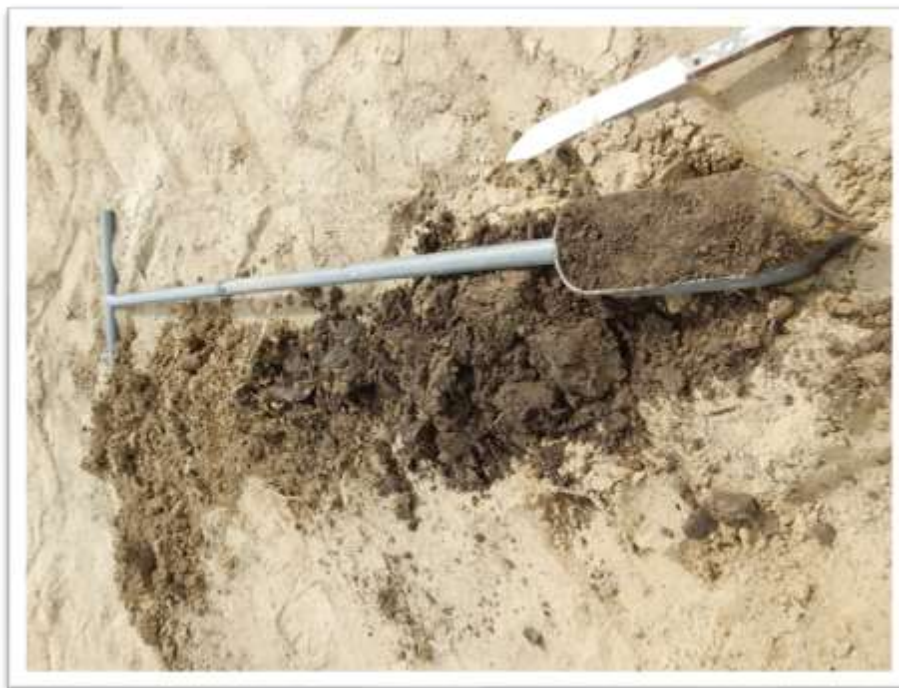
Afb.8. Grondboring op de plaats binnen de vingerling, boorput a.
