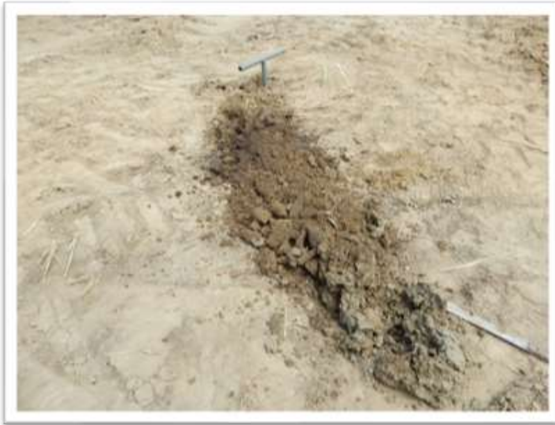
Afb.13. Grondboring locatie voormalig dijktracé voor de dijkdoorbraak. Boorput f.
